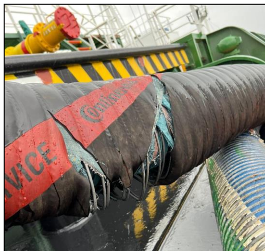
Gambar 4.3 Kerusakan cargo hose Sumber: Dokumentasi Peneliti
