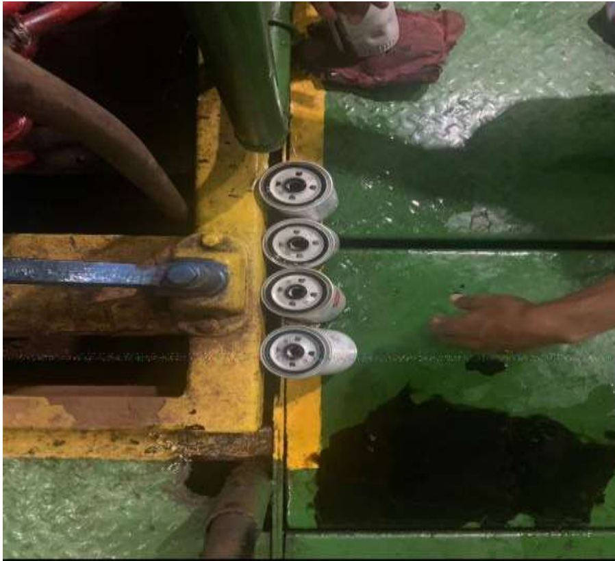
Gambar 5. Perawatan pembersihan dan penggantian filter oli
