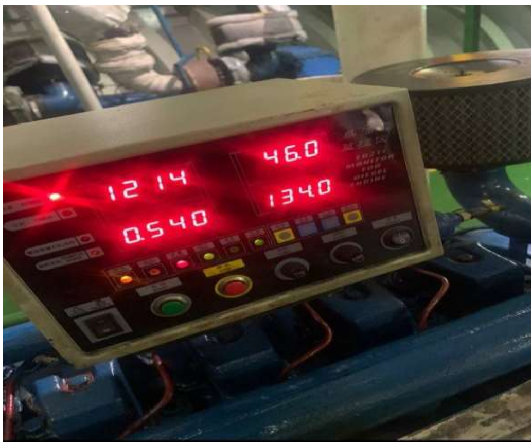
Gambar 4. Suhu pada tekanan oli tinggi Sumber. Dokumentasi pribadi. 2023
