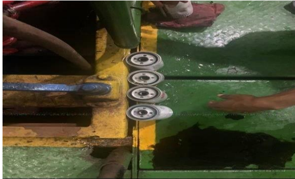
Gambar 2. Perawatan pembersihan dan penggantian filte oli
